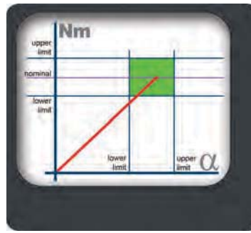
Aprietes dentro limites de Par y angulo (apriete en una ventana)
