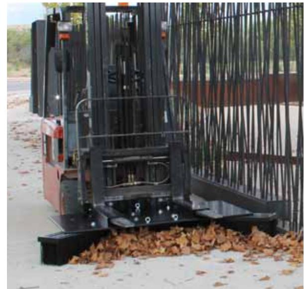
**SWEeper es compatible con toros, tractores, palas excavadoras, dumper, fenwick, etc...**
