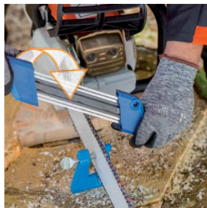
Girando el dispositivo se cambia de afilar los dientes de de un lado a los del otro.
