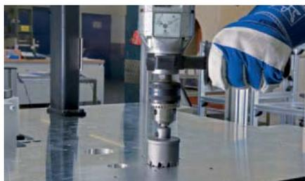
La ejecución profunda (altura de herramienta 35 mm) está concebida para la utilización en superficies abombadas y materiales macizos. La profundidad máxima de corte es de 32 mm.
