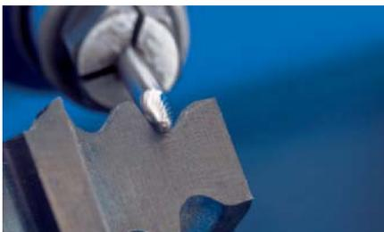
Fresa forma árbol según DIN 8032 con dentado según DIN 8033.
