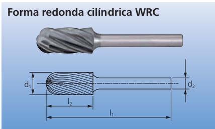
Fresa forma redonda cilíndrica según DIN 8032 con dentado según DIN 8033. Combina las geometrías cilíndrica y esférica.
