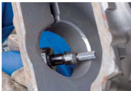
Forma cilíndrica según DIN 8032 con dentado según DIN 8033. La forma ZYAS tiene dentado periférico y frontal.
