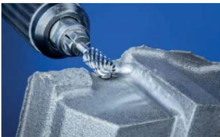
Fresa forma redonda cilíndrica según DIN 8032. Combina las geometrías cilíndrica y esférica.
