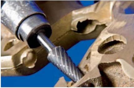
Fresa cónica redonda con cabeza redonda según DIN 8032.
