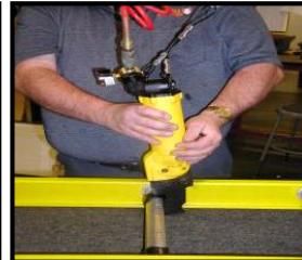
Twist -Tacks, tienen una cabeza de 6,35 mm de diámetro y se pueden colocar hacia arriba o hacia abajo para cumplir con los requisitos del cliente
