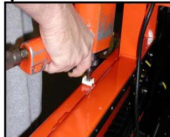
Simplemente coloque el montaje y apriete el gatillo para una fijación permanente.
