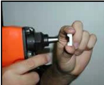
Los Mounts Tack se llevan a cabo de forma segura colocandolos en la punta de la herramienta de aire con un conductor magnético.
