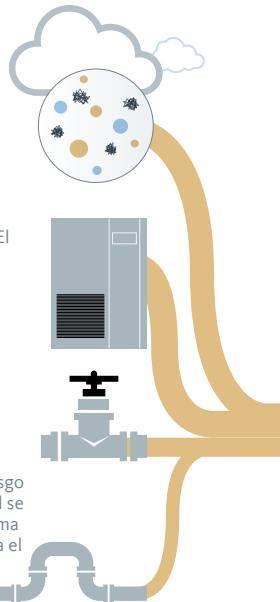
**> El diseño incorrecto de una instalación, el uso inadecuado y un mantenimiento deficiente de los compresores y los componentes de tratamiento pueden provocar contaminación.**
