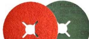
• Soporte de fibra • Con aditivo refrigerante • Aplicaciones: Amolado de soldadura, eliminación de material base y homogeneización de superficies • Biselado de piezas • Ojo trabajar en superficies planas • Para los granos 60+, 80+ y 120+ se utiliza preferentemente el plato rojo liso según medida (64857, 64858 y 64859) • Para el grano 36+ se recomienda utilizar el plato rojo duro (estriado) según medida (64860, 64861 y 64862)
