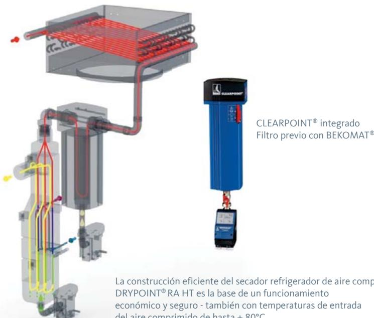
La construcción eficiente del secador refrigerador de aire comprimido DRYPOINT® RA HT es la base de un funcionamiento económico y seguro - también con temperaturas de entrada del aire comprimido de hasta + 80°C.
