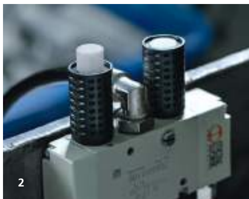
2. El silenciador después de una cierta cantidad de obstrucción.
