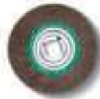
CEPILLO DE ACERO Ø 250 mm x 60 mm, con resistencia nominal muy elevada para un uso especialmente rentable, taladro de alojamiento Ø 51 mm. 0,2 mm de grosor de alambre para tubos y perfiles de paredes finas. 0,35 mm de grosor de alambre para todo tipo de aplicaciones. 0,5 mm de grosor de alambre para tubos y perfiles de paredes gruesas y una elevada potencia de desbarbado. Modelo de acero inoxidable
