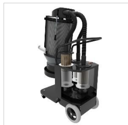
1 filtro primario de cartucho HEPA + PTFE con protector de acero inoxidable + 3 filtros secundario HEPA 13 con 55.000 cm 2 totales de superficie filtrante.
